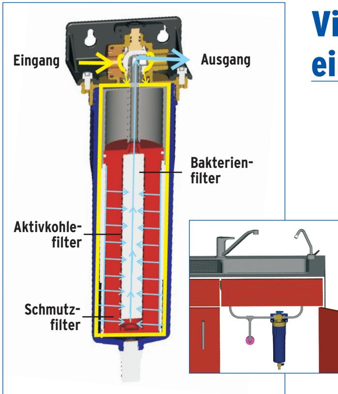
**SYR gibt Ihnen das gute Trink- und Kochgefühl wieder zurück: Mit SYR POU max, dem rückspülbaren Hochleistungs-Trinkwasserfilter, der vier Filter in einem Gerät vereint - für die makellose, erschwingliche und unkomplizierte Aufbereitung des Trinkwassers.**
